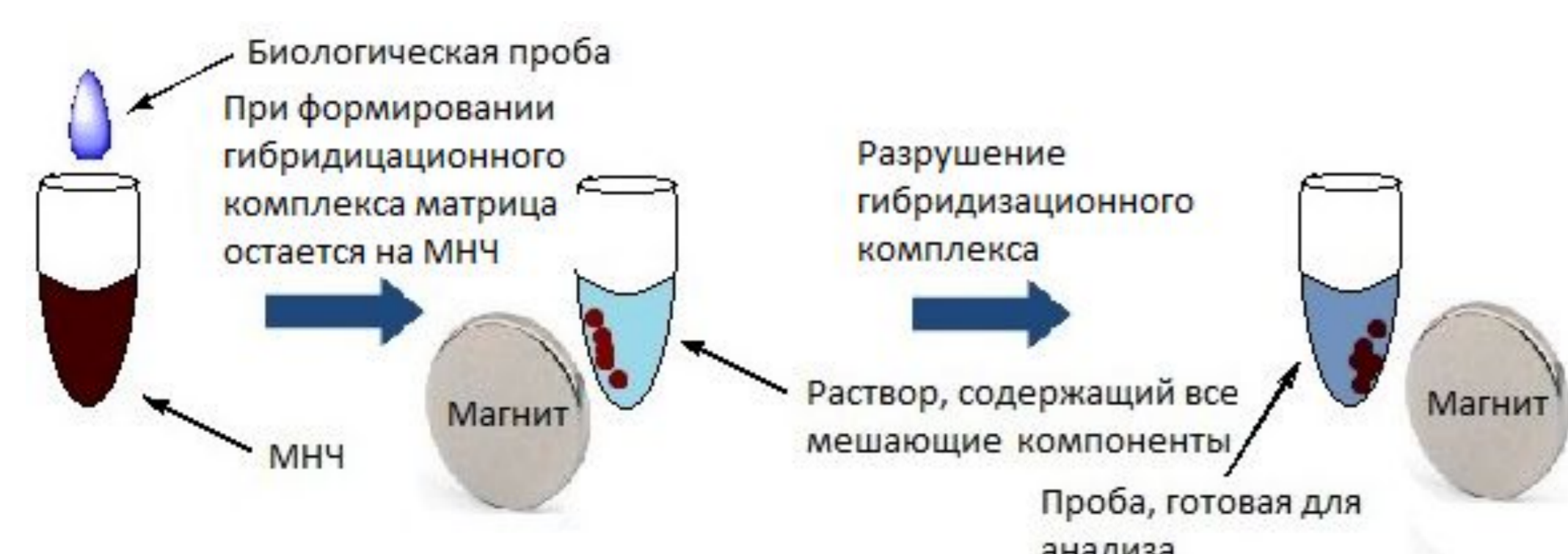
Схема иммобилизации олигонуклеотида на МНЧ с последующей гибридизацией с флуоресцентно-меченой матрицей.
